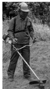
Gefahren: Herumfliegende Steine, Lärm, Vibrationen, Rückschlag, Schnittverletzungen.
